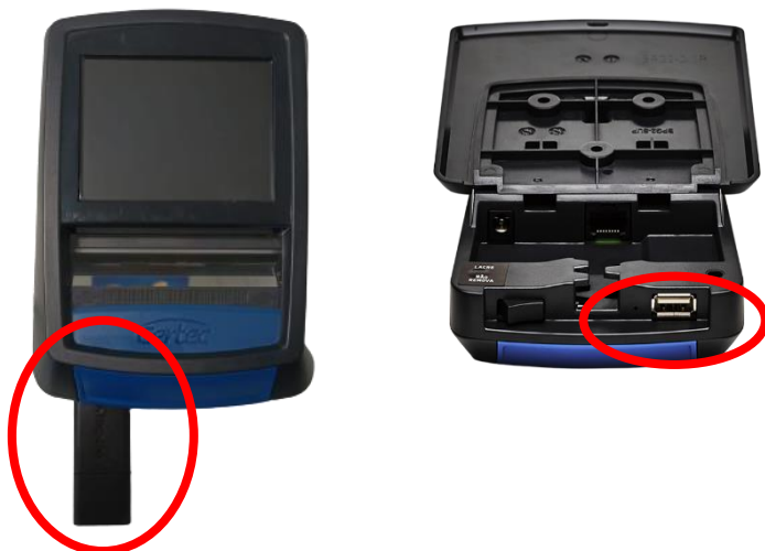
Fotos acima ilustram a conexão do pen drive nos modelos G2 e G2S.
